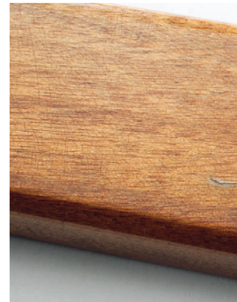
Craquelé in het systeem gaat op goed moment over in barstvorming door en door. Dit is de Stoppani Vernis 910 met Stoppani Classic Yacht UV.
