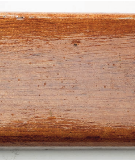
De Deks Olje D1 en D2 van Owatrol hebben de duurtest behoorlijk goed doorstaan. Op de randen zijn wel donkere plekje te zien: inwatering.
