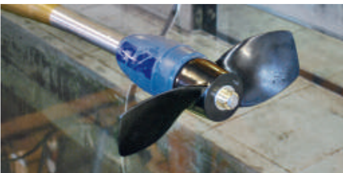
Der für unsere Yachtkonfiguration empfohlene Festflügelpropeller von Volvo lieferte spannende Vergleichswerte
