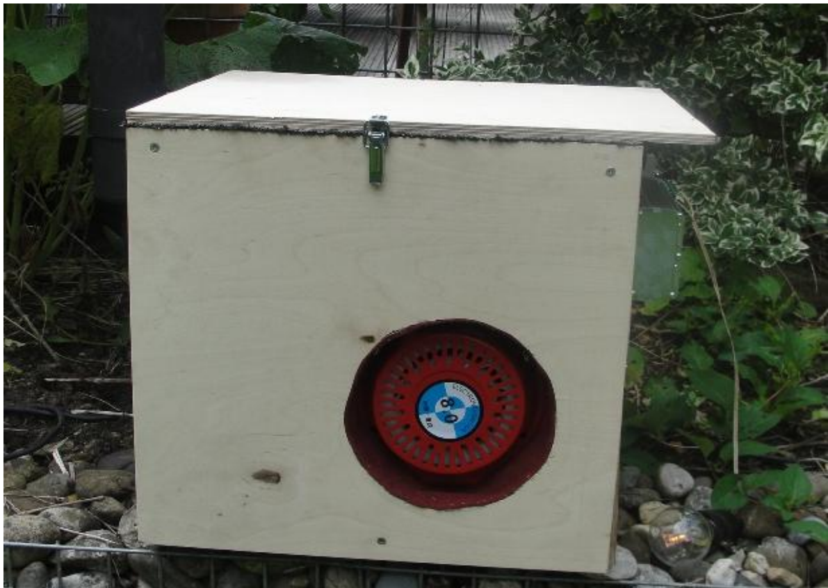
2,5kW 57VDC generator met 'auto start' en 'auto stop'. Het heet 'portable' te zijn, maar je tilt je een breuk!
