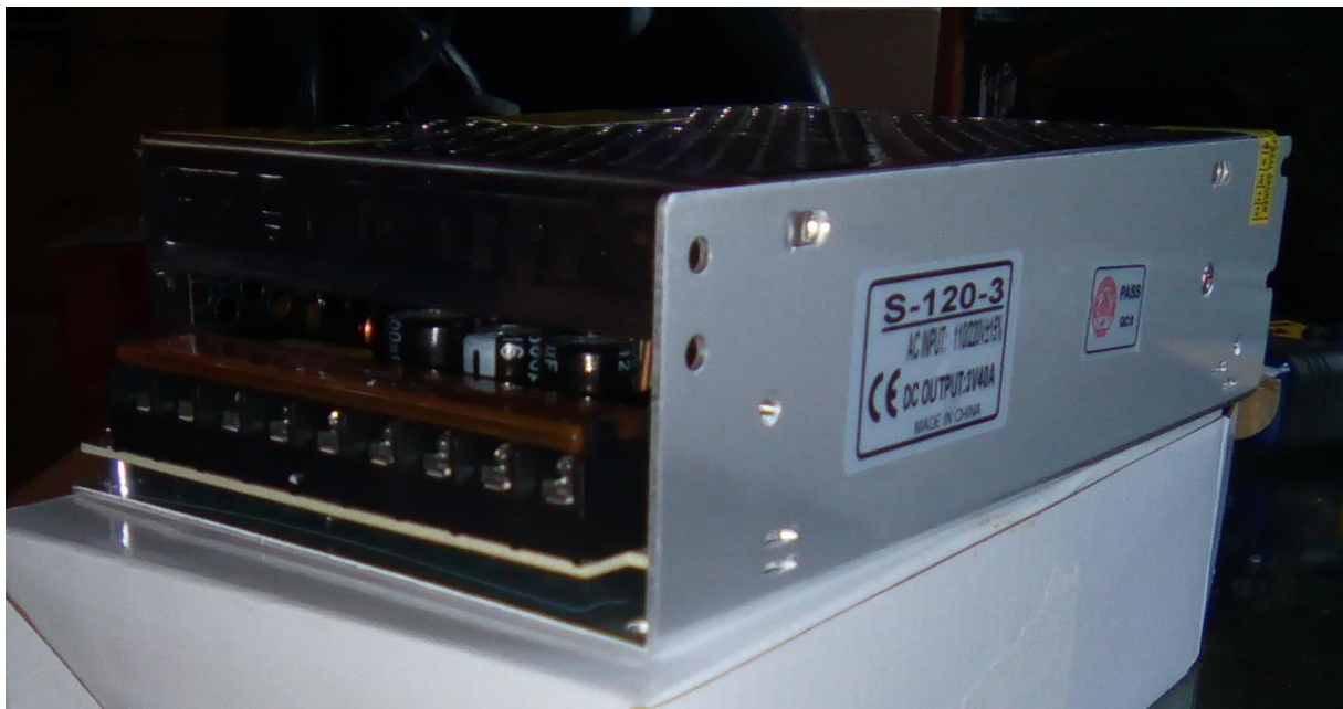
Een 230V/110V omschakelbare SMPS voeding voor 3,3V en 40A laadstroom.
