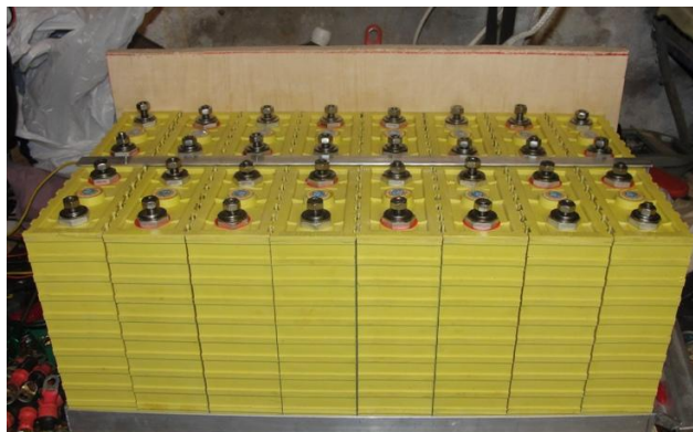
LFP accubank van 16 100Ah cellen (51,2V nominaal, maximale laadspanning 55,2V bij 3,45V per cel)
