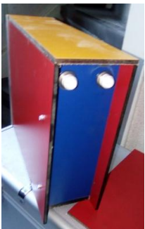
Trespa accubak voor 4 50Ah LFP pouch-cellen en RvS M8 Accupolen binnen de omtrek van de bak (witte dopjes). Voorin de bak zit de elektronica voor het laden en voor de onderspanning bescherming. De keuze van de kleuren is die zoals gebruikt door de Stijlgroep. (Mondriaan cs)
