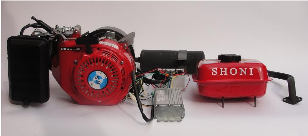
v.l.n.r: generator met luchtfilter en carburateur, elektronisch regelsysteem, brandstoftank en flexibele uitlaat op de achtergrond.
