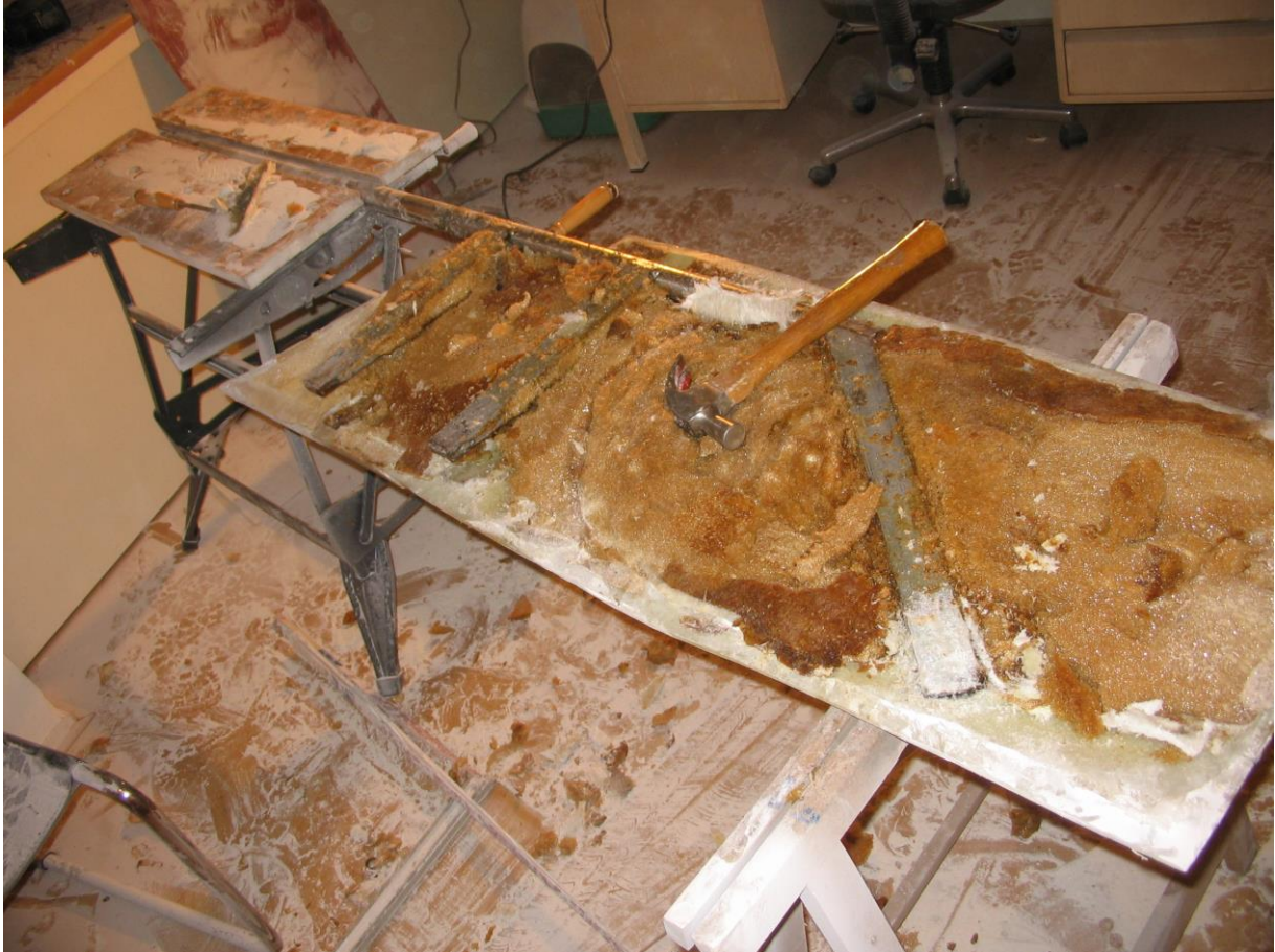
Losmaken van het RVS binnenwerk. De as en eindstukken van de V-strips zijn ingelamineerd
