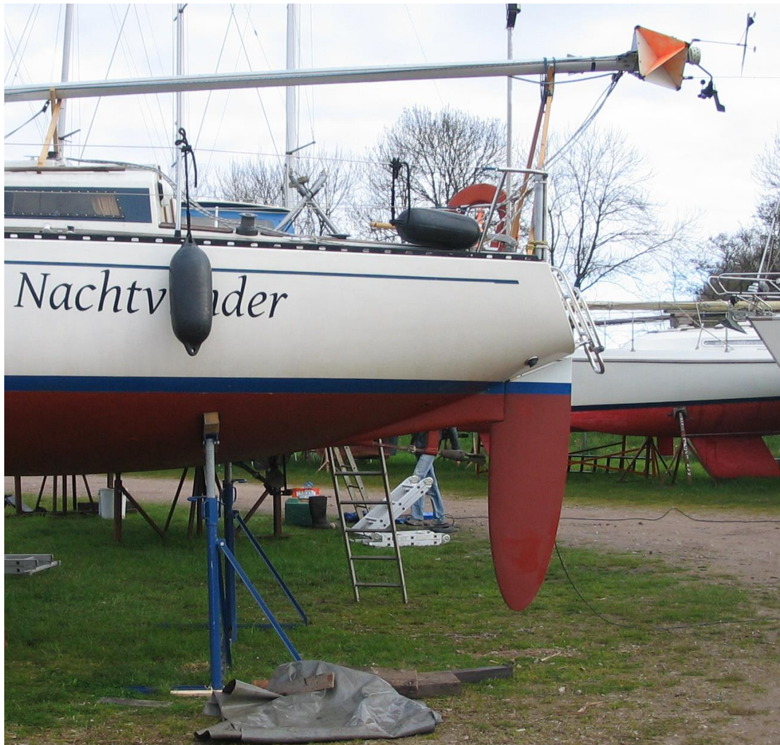
Eindresultaat. Het oude roer was verwijderd toen de boot in de kraan hing. Om het nieuwe roer te passen moest een flink gat in de grond gegraven worden ;)
