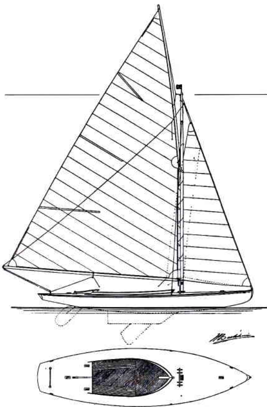
Kiel- en middenzwaardjacht, lang 7 m, breed 1,92 m, diepgang zonder zwaard 0,50 m, met zwaard 1,10 m. Zeiloppervlak 32 m 2 . Ontwerp W. Beekhuis, werf „Navis”, Loosdrecht.
