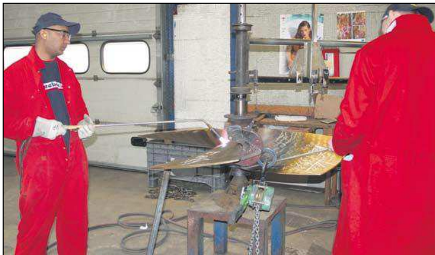
• Twee medewerkers van Euroschoef repareren een schroef. Indien gewenst worden schroeven van tipplaten voorzien. (Foto's Hans Heynen)
