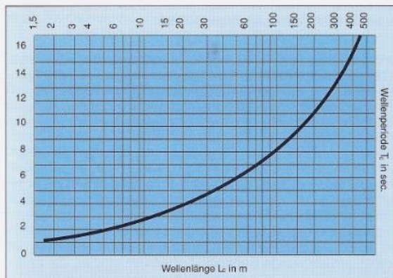
Abb. 9.7 Zusammenhang zwischen Wellenlänge und Wellenperiode in tiefem Wasser
