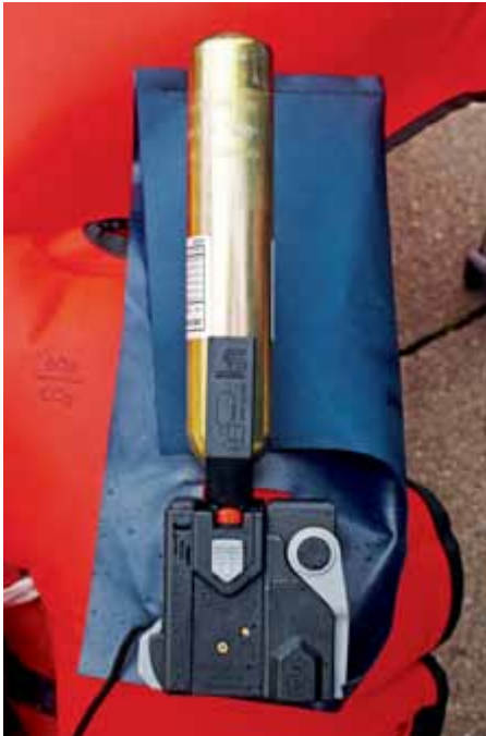
Secumars Topmodell Secumatic 4001 S an der Weste Scout 3D: Der aufwändige Automat ist mit einem Bajonettverschluss für die Patrone ausgestattet, versehentliches Lösen ist damit ausgeschlossen
