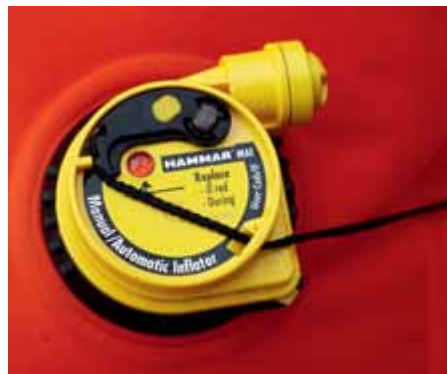
Der Hammar-Automat der Deckvest löst in etwa zehn Zentimeter Tiefe durch Wasserdruck aus. Die Patrone sitzt in der Blase
