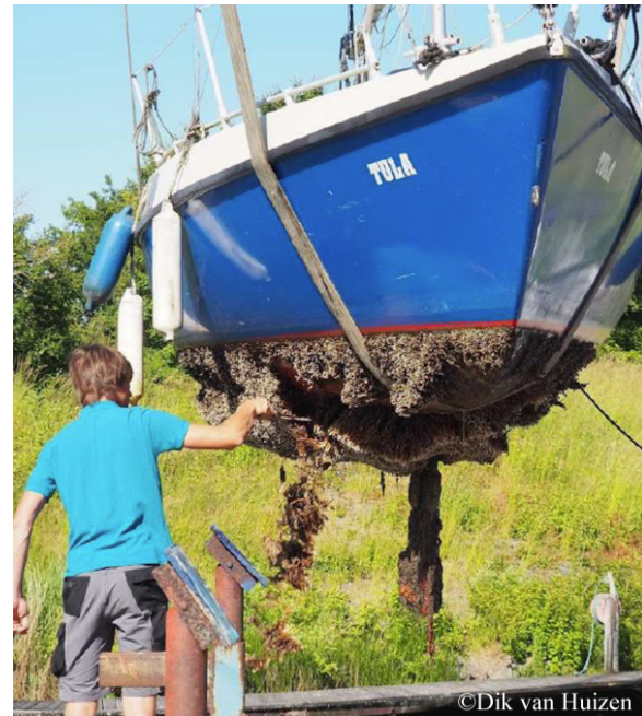
Fig. 1. Trompetkalkkokerworm aangroei op een boot uit de haven van WSV Herkingen. ©Dik van Huizen
