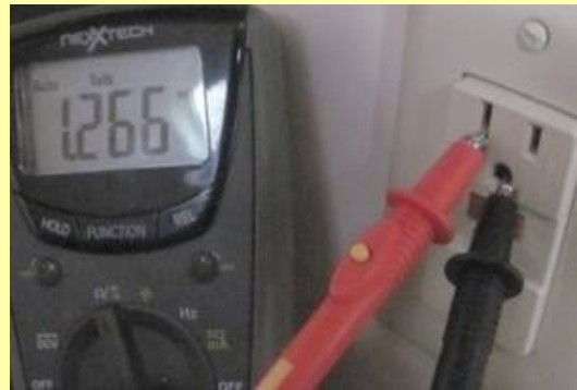
Red meetpen in neutraal, zwarte in aarde 1,266M \Omega (megaohms) = 1.266.000 \Omega (ohms)
