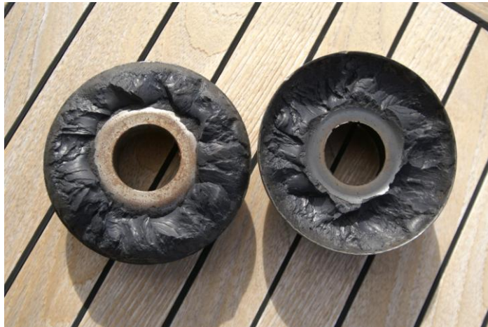
De afgescheurde flexibele koppeling
