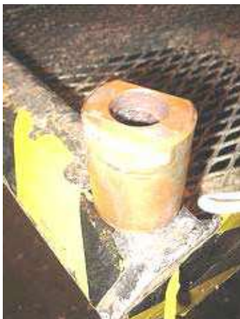
Stap 7 - De bronzen bus (heugel) waar het spindel in draait.
