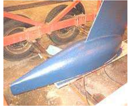
Stap 12 - De kiel na 5 maal epoxy en eerste laag antifouling.
