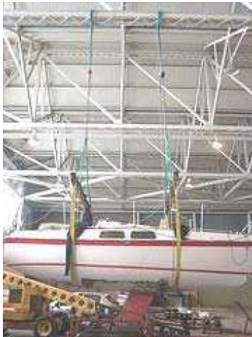
Stap 1 - Boot in hijsbanden en de kiel er uit laten zakken.
