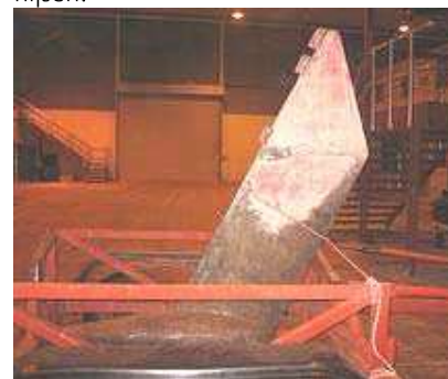
Stap 6 - De kiel halverwege met de renovatie.
