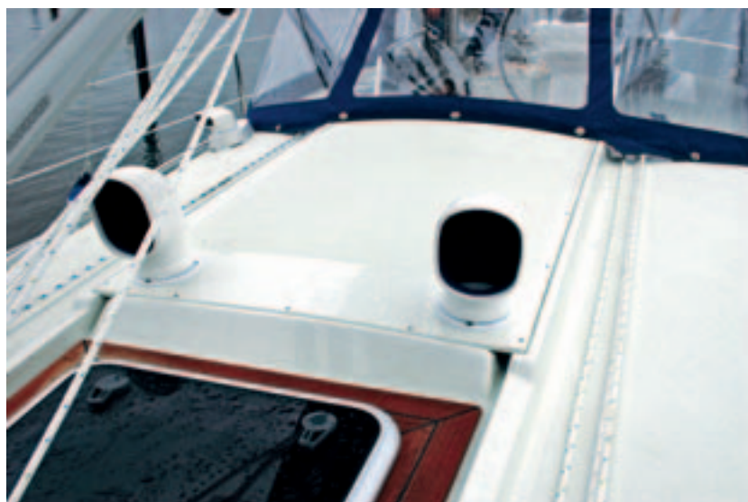
Die Lüfter arbeiten permanent durch das Schiebeluk
