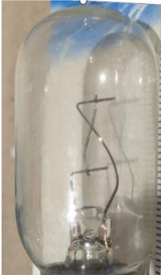
Een gloeilamp met scheve draad. Zal zeker overstraling geven. Max 1 mm scheef is toegestaan.
