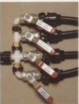
Die Klappen mit Viertelumdrehung, auf Feststangen montiert.
